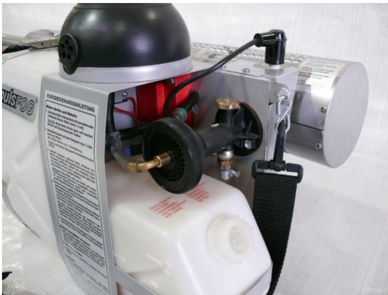
Abb. 2: Benzintank, Vergaser, Rückschlagventil und Resonator.
