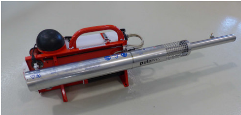
Abb. 5: Heiß werdende Teile sind durch ein Schutzgitter vor der Berührung geschützt. Das Batteriefach ist unterhalb des Nebelrohres angeordnet.
