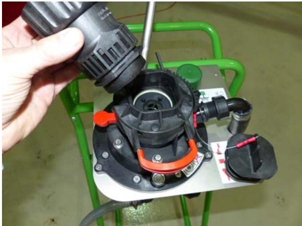
Abb. 2: Die Gebindeadapter passen für 63 mm Schraubverschlüsse.
