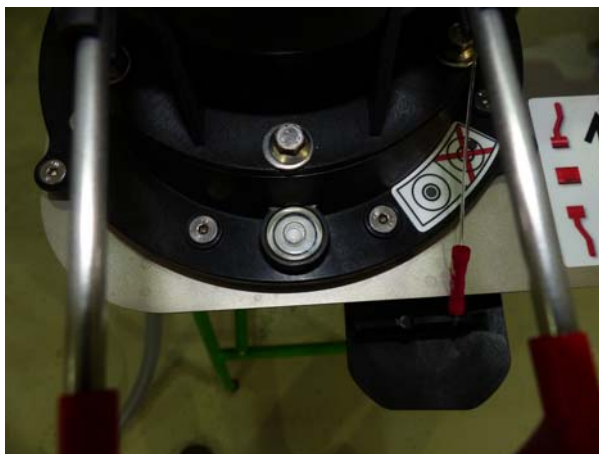
Abb. 3: Für das genaue Abmessen von Teilmengen muss das Füllsystem möglichst waagrecht aufgestellt werden. Eine Libelle erleichtert die Ausrichtung.
