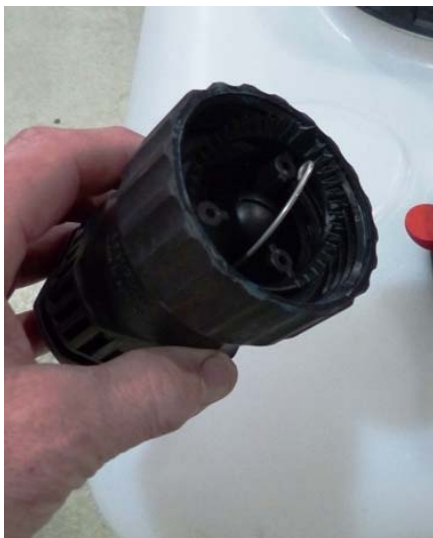
Abb. 4: Die Gebindeadapter ersetzen den normalen Gebindedeckel.
