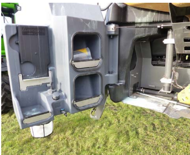
Bild 15: Auf der linken Seite befindet sich der Stauraum für Utensilien und persönliche Schutzausrüstung sowie eine kleine klappbare Ablage und der Frischwasserhahn mit Seifenspender.
