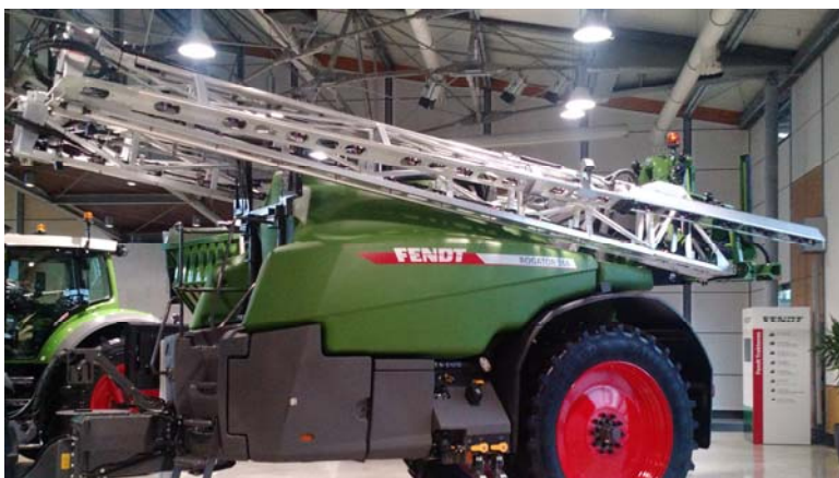
Bild 10: Das Gestänge wird an einem Zentral-Hubmast geführt.
