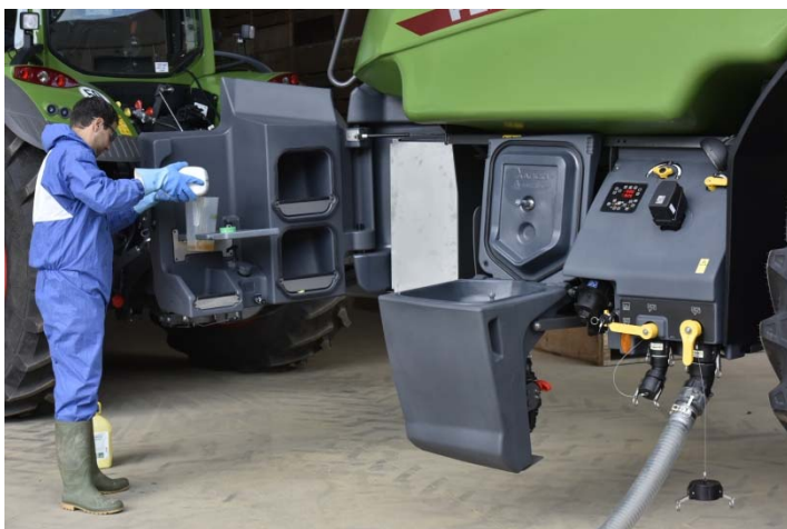
Bild 12 : Das Bedienzentrum auf der linken Geräteseite ist übersichtlich und weist genügend Verstaumöglichkeiten auf, die Einspülschleuse ist auf eine angenehme Höhe ausschwenkbar, innen glatt und erzeugt bei Betrieb einen rotierenden Strudel.
