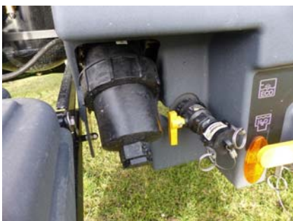
Bild 8: Die Zentrifugalpumpe Hypro 9306 C verbirgt sich hinter einer Abdeckung direkt neben dem Druckfilter (Bild).
