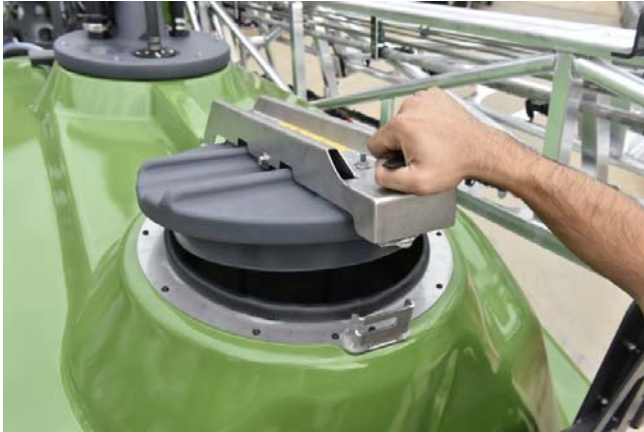
Bild 5 und 6: 6600 l Flüssigkeitsbehälter (oben) mit gut zugänglichem Deckel, Display für das Füllen und Umpumpen mit Anzeigen für die Füllstände von Hauptbehälter und Spülwasserbehälter (rechts)
