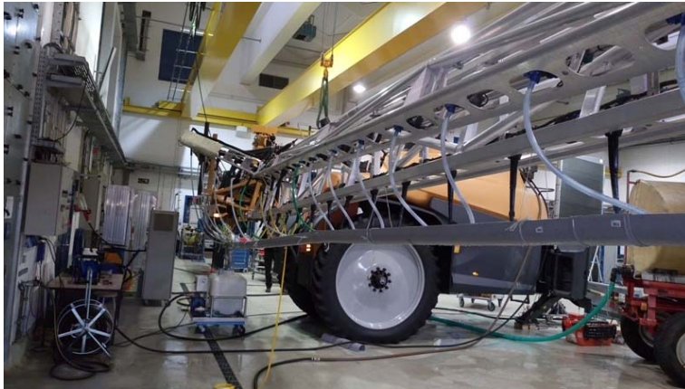
Bild 9: Das Gestänge ist aus Aluminium gefertigt und lediglich zweimal gefaltet.
