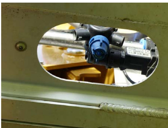
Bild 11: Fünffach Düsenkörper mit elektrischen Schaltventilen von ARAG.
