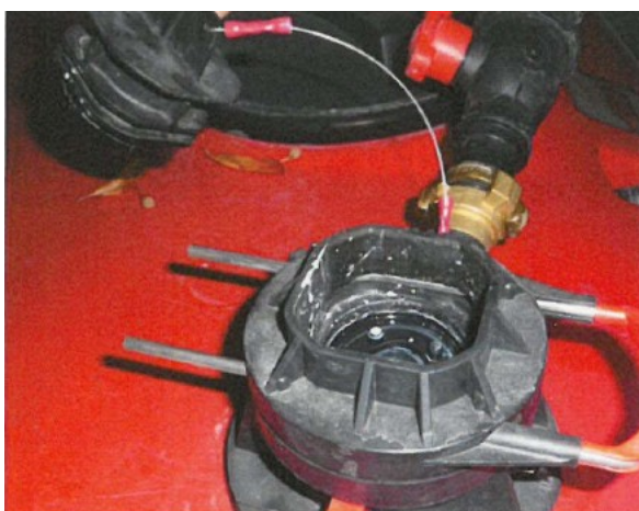
Abb. 3: Die „easyFlow“ Adapter lassen sich auch an Sprühgerätebehälter adaptieren. Vor Verschmutzung bei Nichtgebrauch schützt eine Verschlusskappe.
