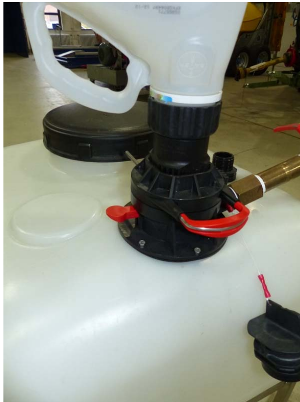
Füllsystem für Pflanzenschutzmittel Agrotop „easyFlow“
