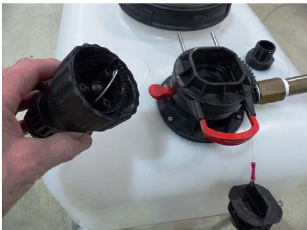
Abb. 2: Der Tank-Adapter muss auf einer möglichst waagerechten Fläche montiert werden. Die Gebinde-Adapter passen für 63 mm Schraubverschlüsse.
