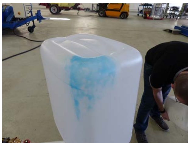
Abb. 4: Die Gebinde sollten während des Reinigungsvorganges von Hand gedreht werden, damit alle Ecken vom Reinigungsstrahl getroffen werden.
