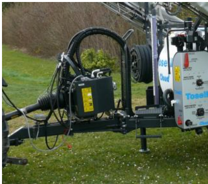
Abb. 2 und 3: Das Fahrgestell gestattet einen spur-treuen Nachlauf. Die Pumpeneinheit ist auf der Lenkdeichsel platziert - die Gelenkwelle wird damit bei Kurvenfahrten wenig strapaziert.
