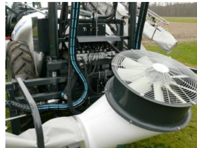
Abb. 6 und 7: Die äußeren Ausleger sind aus Edelstahl gefertigt. Das geregelte Axialgebläse mit Luftverteiler kann den Tropfentransport in blattrreichen Kulturen verbessern.
