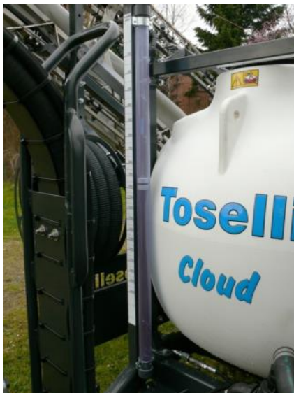
Abb. 4: Der Füllstand wird mit einer Schwimmerskala angezeigt.
