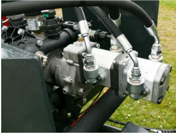
Abb. 5: Die Pumpe Imovilli D 274 mit angeflanschter Hydropumpe ist mitsamt dem Ölreservoir auf der Lenkdeichsel montiert.
