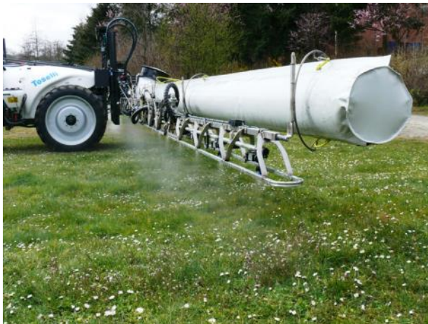
Abb. 6 und 7: Die äußeren Ausleger sind aus Edelstahl gefertigt. Das geregelte Axialgebläse mit Luftverteiler kann den Tropfentransport in blattrreichen Kulturen verbessern.
