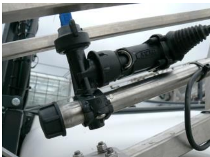
Abb. 8: Die letzten Düsen werden über elektrische Einzeldüsen-schaltung betrieben.
