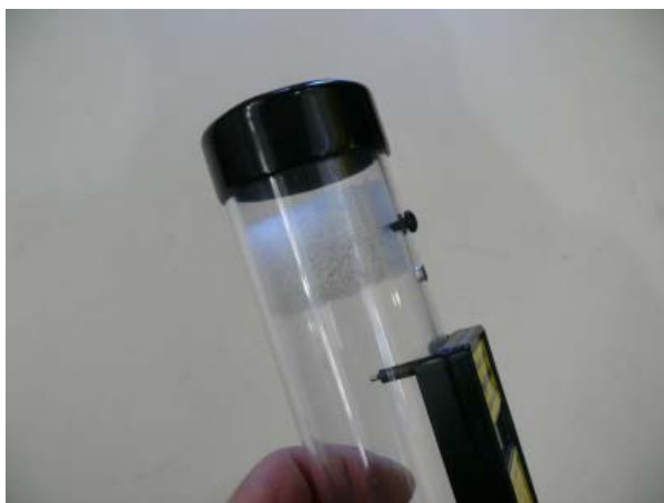
Abb. 3: Eine Gewebeeinlage verhindert das Herausspritzen von Wasser.
