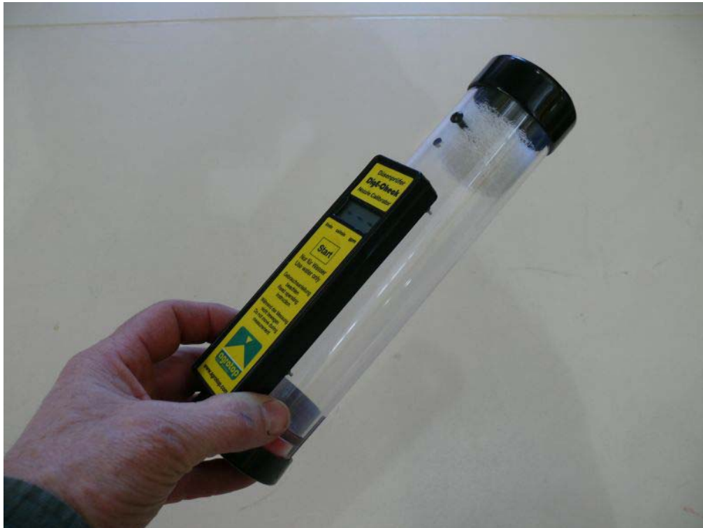
Messeinrichtung Einzeldüsentester „DigE-Check“
