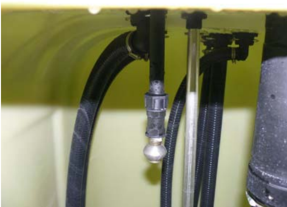
Abb. 5: Die Platzierung der Reinigungsdüsen muss sorgfältig erfolgen, um Abschattungen auf der Behälterwand zu vermeiden.
