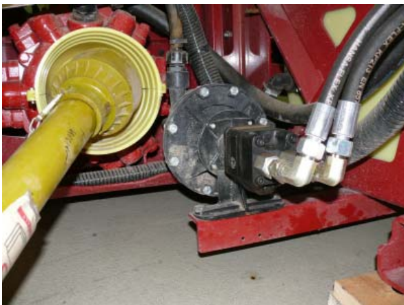
Abb. 3: Ein Platz für die hydraulisch angetriebene Pumpe lässt sich in der Regel auch bei Anbaugeräten leicht finden.
