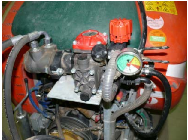
Bild 2: Nachrüstsatz 11600842 für Sprühgeräte
