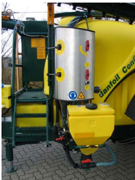
Abb. 9: Bedienzentrum auf der linken Geräteseite mit den Vorwahlhähnen für die Saug- (oben links) und Druckseite (unten links) sowie die Rührwerksleistungsregelung (oben rechts). Die Einspüleinrichtung befindet sich in Transportstellung.
