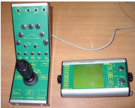
Abb. 12: Bedienteil „AgroJoy 2001“ links und Terminal „AgroMaster III XL“ rechts. Das Terminal kommuniziert lediglich über ein Koaxialkabel (Bild rechts) mit dem Spritzgerät.
