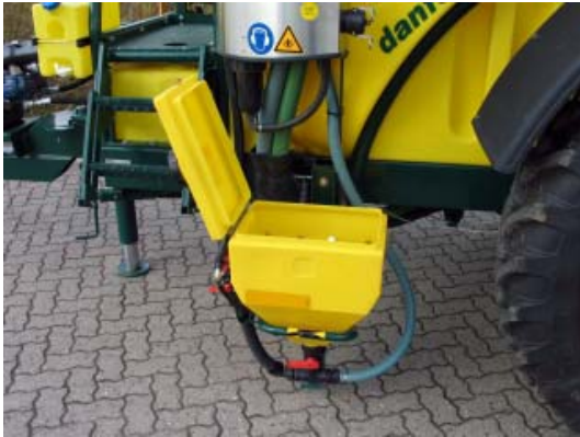
Abb. 10 und 11: Einspülschleuse (in Arbeitsstellung ausgeschwenkt) an der linken Geräteseite. Das eingesetzte Edelstahlkreuz verhindert das Ansaugen von Fremdkörpern.
