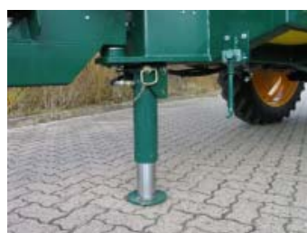
Abb. 2 (oben) und Abb. 3 (links): Fahrgestell mit gefederter Achse und hydraulischem Stützfuß.
