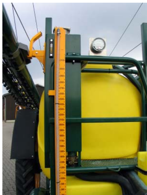
Abb. 4: Arbeitsplattform und Behälterinhaltsskala auf der rechten Geräteseite
