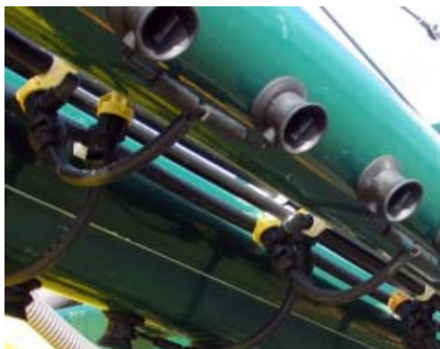
Abb. 8: Je zwei Zerstäuber werden über ein Membranventil und zwei Dosierscheiben gespeist.
