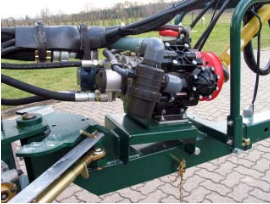
Abb. 5: Vierkammer-Membranpumpe mit angeflanschem Hydromotor für die Hydraulikfunktionen des Gerätes (eigenes Hydrauliksystem).
