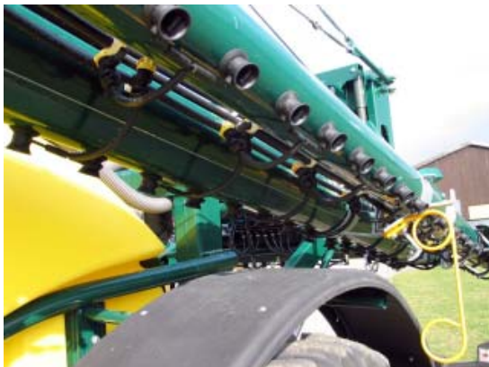
Abb. 6: seitlich geklapptes Spritzgestänge aus GFK-Rohren mit Danfoil-Zerstäubern (6 Zerstäuber je m Arbeitsbreite)
