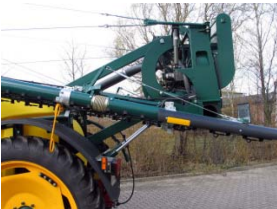
Abb. 7: Das Gestänge verfügt über eine Parallelogramm-Aufhängung, Pendleinrichtung und Hanganpassung. Die äußeren, 1,65 m breiten Segmente, können Hindernissen nach vorn und hinten ausweichen.
