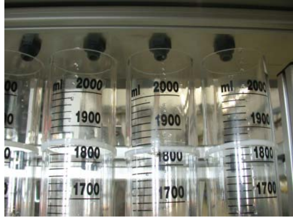
Abb. 6: Messzylinder mit aufgeklebter Skala
