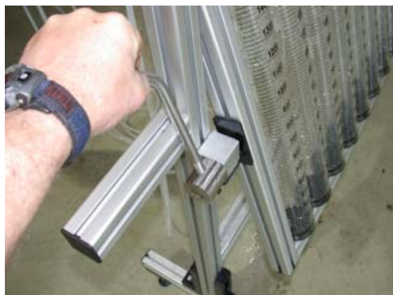
Abb. 4: Schwenkhebel für das Befüllen, Ablesen und Entleeren der Zylinder. Hier Befüllposition.
