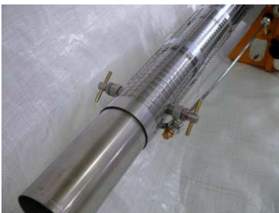
Abb. 4: Die Dosierdüsen befinden sich am Nebelrohr und können werkzeuglos getauscht werden.
