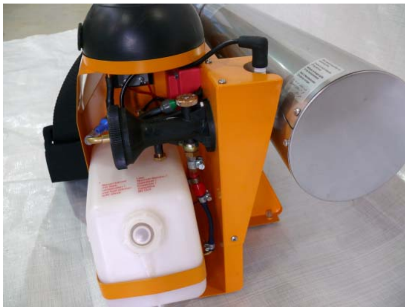
Abb. 2: Benzintank, Vergaser, Rückschlagventil und Resonator.
