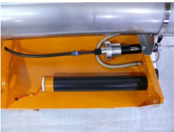
Abb. 5: Der Membranzylinder der Abschaltautomatik und das Batteriefach sind unterhalb des Nebelrohres angeordnet.
